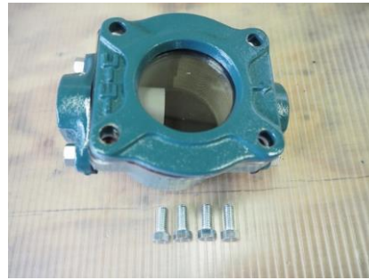
②蓋ボルトを取り外す。少しづつ順に緩めて外してください。
